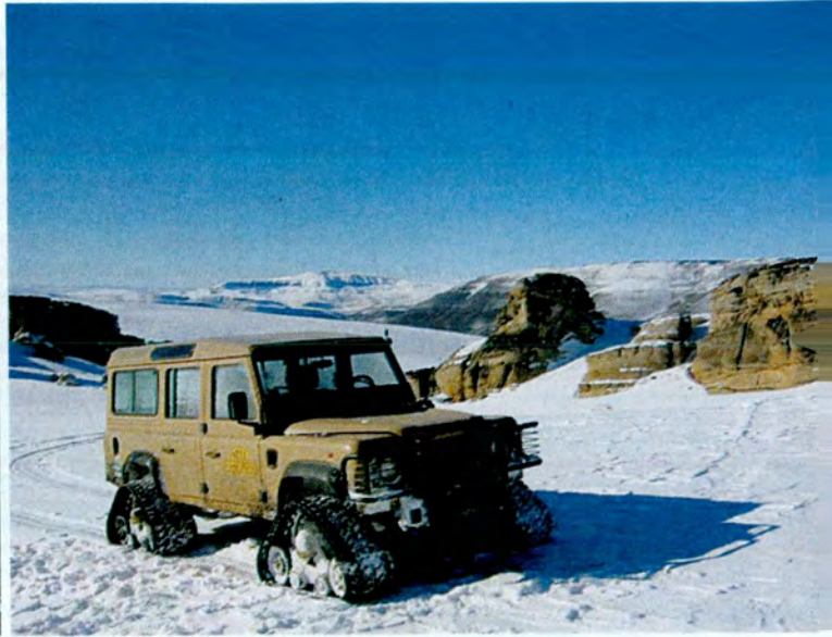
Orugas especiales: únicos vehículos realmente eficaces sobre la nieve y el hielo.
