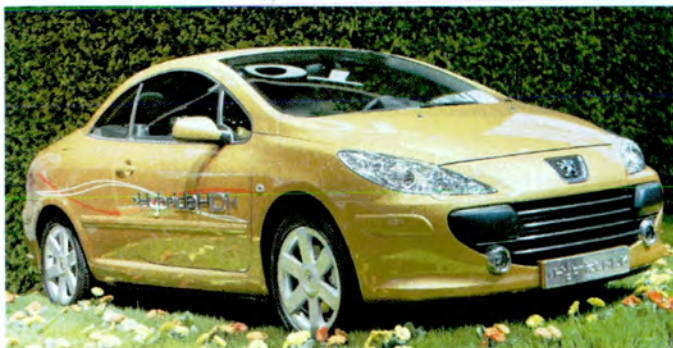
PEUGEOT 307 CC HYBRID. Tiene un motor diesel de 1.6 litro y otro eléctrico de 16 kw. Su consumo es de sólo 3,7 litros cada 100 km.
