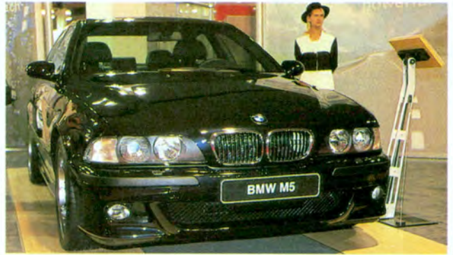
La furiosa berlina BMW M5 tiene un motor V8 de 5.0 litros y 400 CV, su velocidad máxima se limita a 250 km/h y acelera de 0 a 100 km/h en 5s3.
