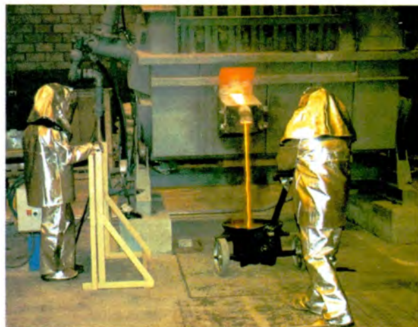
Trajes que se asemejan a los de los filmes espaciales protegen a los operarios en la colada.
