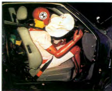
La foto superior muestra uno de los muñecos instantes después de la colisión, y con el "air bag" desinflándose. Debajo, otra parte de los ensayos determina el grado de protección a niños que viajan en un asiento infantil recomendado por el constructor.
