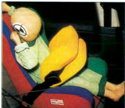
(los famosos "crash test dummies"), dispuestos de dos dotados de múltiples sensores para los impactos de frente, en los cuales se evalúan los riesgos de lesiones en cabeza, cuello, rostro, rodillas, muslos, pel-
