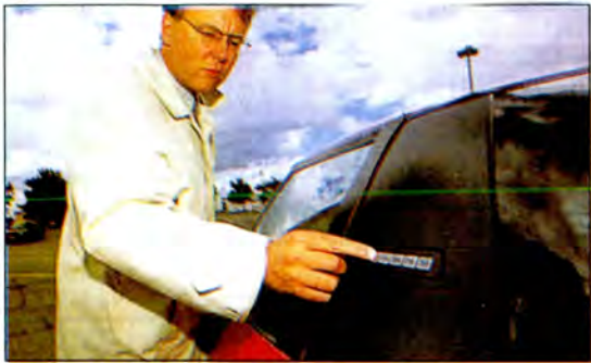
La combinación mágica: para abrir las puertas del EV-1 hay que introducir un código de cinco cifras en vez de una llave.
