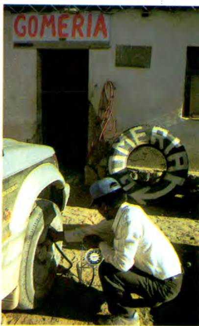
Verificación de la presión de inflado en San Antonio de los Cobres (3.775 metros): el medidor indica 40 libras, que equivale a 32 libras en la llanura.
