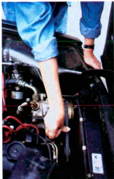
Haciendo fuerza simplemente con el pulgar, puede comprobarse si la correa tiene aún suficiente tensión.
