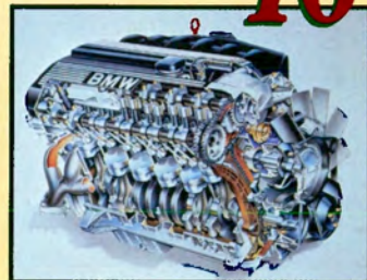
Algo de lo muy moderno en motores: admisión y distribución variables.
