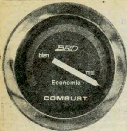
El vacuómetro: El automovilista conduce observando las oscilaciones de la aguja y puede así obtener una sustancial reducción del gasto de nafta.
