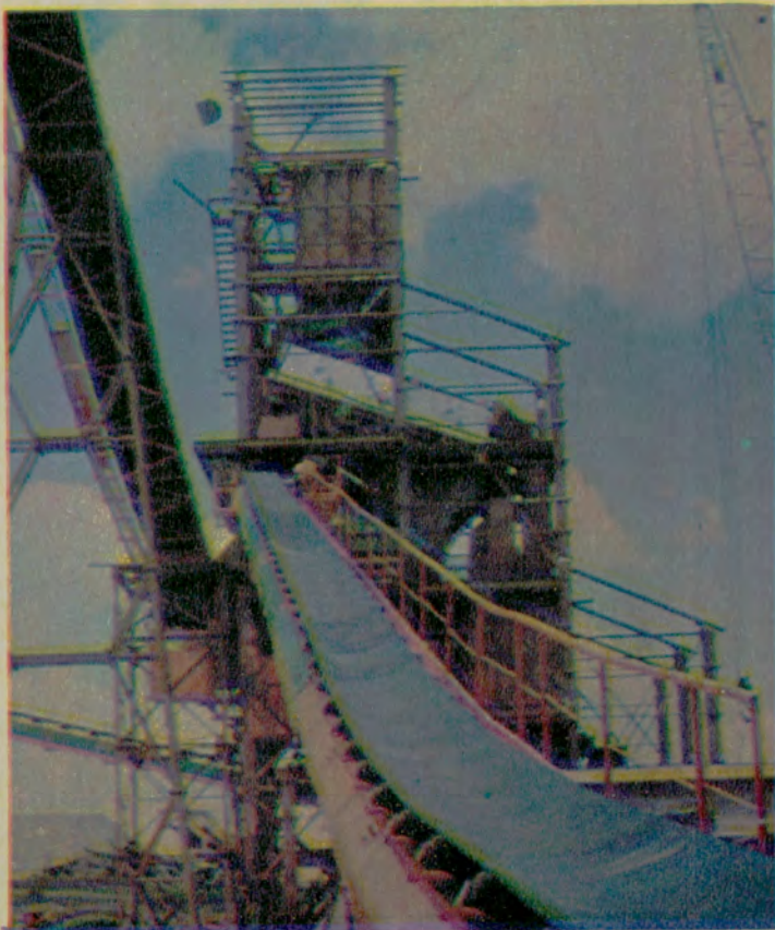
Las cintas transportadoras de materiales forman parte de una de las más modernas plantas del mundo para producir hormigón.
