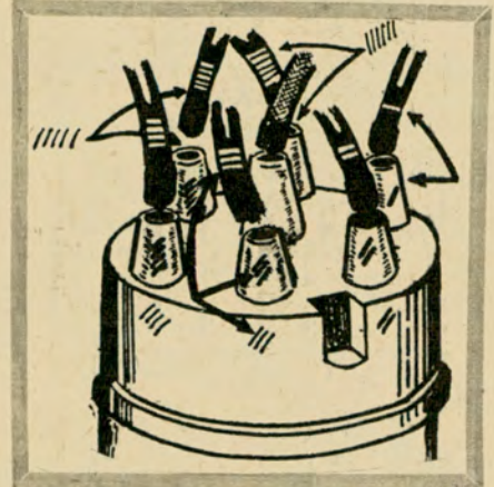
Fig. 3. Si es necesario desenchufar los cables de la tapa del distribuidor, márkelos correlativamente, así como sus respectivas boquillas, de la manera indicada en el gráfico, para restituirlos luego a su sitio sin contratiempos.
