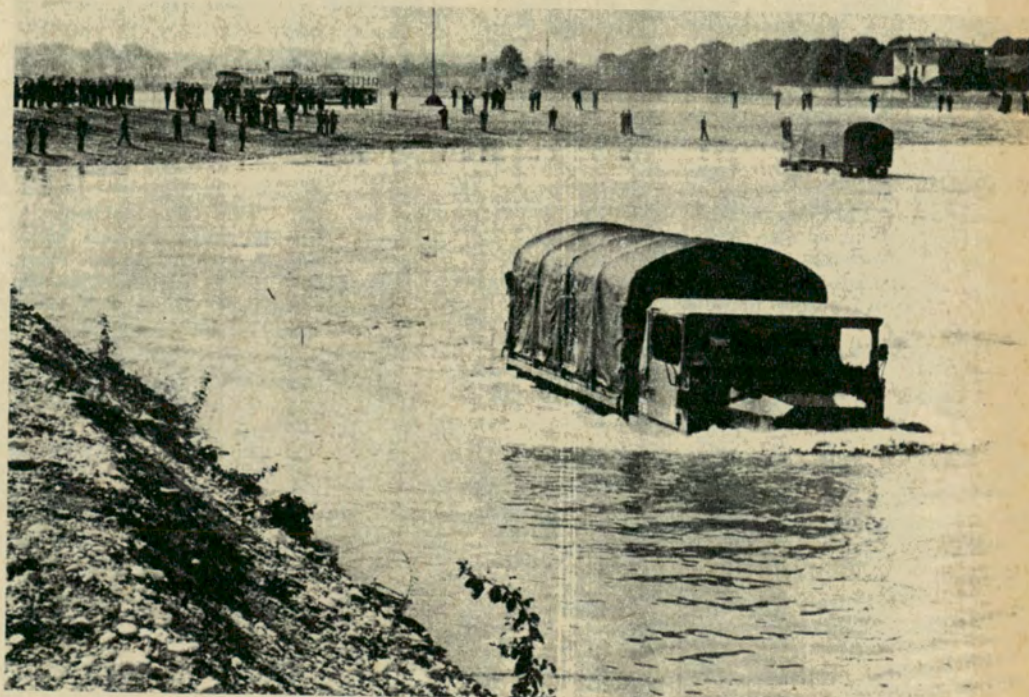
En el lago de pruebas de la fábrica, ubicado en Bourg-en-Bresse, el novedoso camión anfibia Berliet nos da una muestra cabal de sus insólitas posibilidades.
