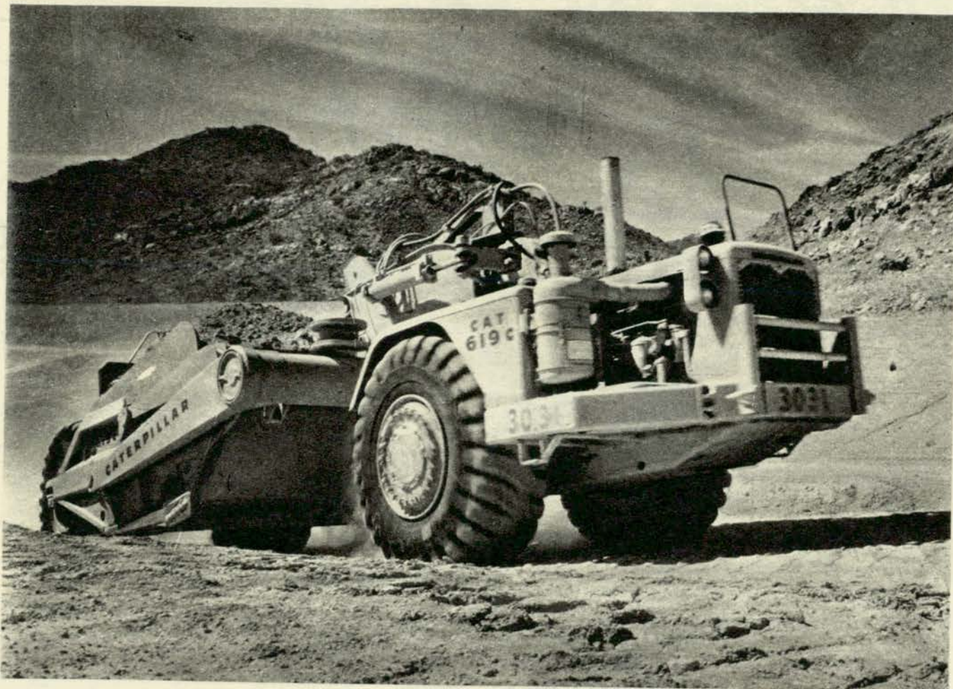
Motopala 619C de Panedlle Argentina S.A. trabajando entre San Julián y Rfo Gallegos sobre la Ruta 3
