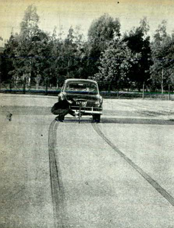
Los frenos, una de las características mecánicas más notables del Peugeot, lo detienen en muy corto espacio. Las marcas de los neumáticos nos muestran la distancia recorrida al frenar a 100 Km/h.
