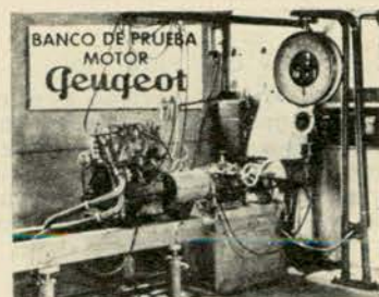
BANCO DE PRUEBAS para el ensayo de motores PEUGEOT 403 y 404
