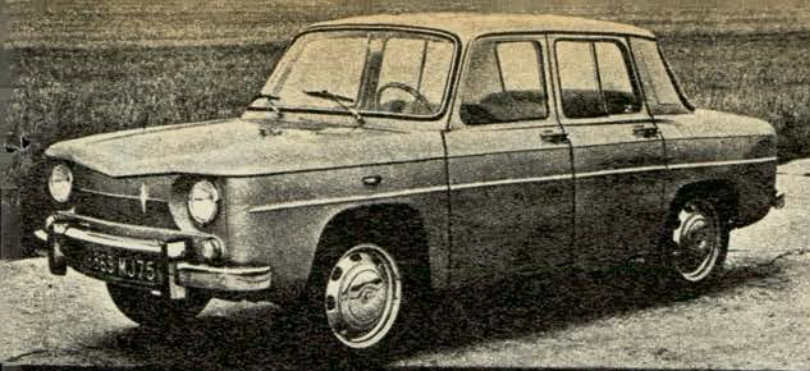
El Renault R 8 con cuatro frenos a disco, motor trasero de 956 cc., que en pruebas de velocidad alcanzó los 125 kilómetros por hora.
