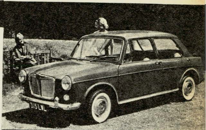
Este es el novedoso M G 1100 de tracción delantera, que tiene colocado el motor en forma transversal y suspensión "Hydroelastic".
