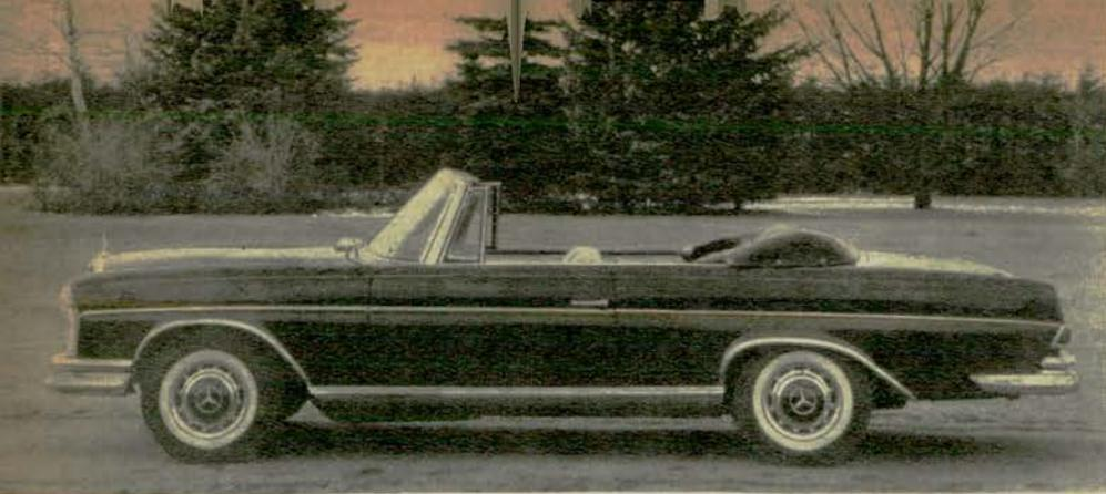
He aquí el Mercedes Benz 300 SE, con motor de inyección de nafta y con suspensión neumática de aire.
