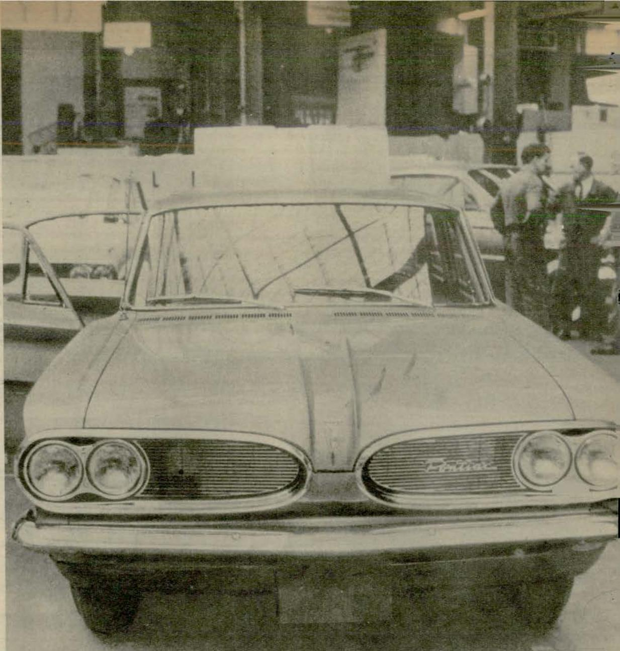
*El Pontiac Tempest es el único coche de fabricación americana con motor de 4 cilindros (3.200 cc.), y es el único en el mundo con árbol de transmisión flexible, sin juntas elásticas.*
